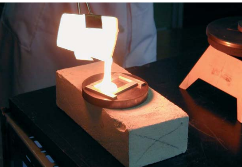
Vazamento das escórias fundidas no laboratório do DCM
