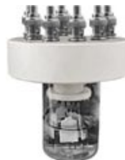
Protótipo de conjunto biosensores químicos produzidos a partir de uma camada da enzima Jacalina adsorvida sobre camadas sequenciais de polielectrólitos e utilizados para a detecção de contaminantes agrícolas de herbicidas em meio aquoso
